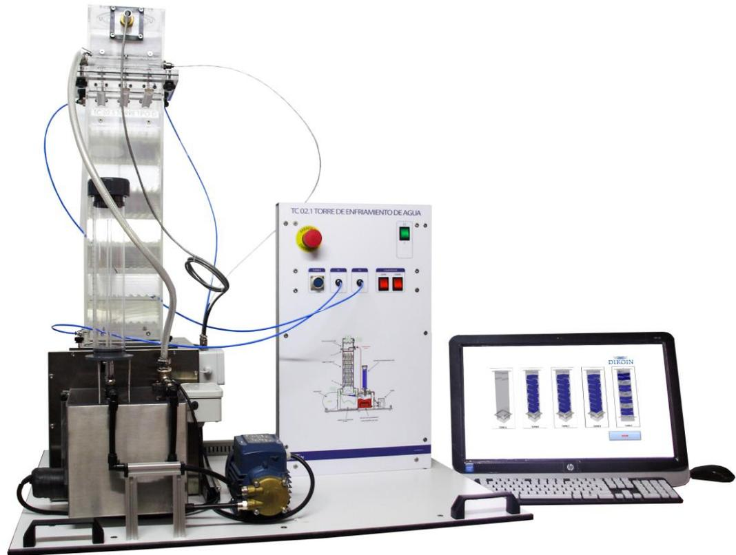
El equipo TC 02.1, muestra un método de enfriamiento de agua habitual en la industria. Este método consiste en enfriar el agua caliente hasta la temperatura ambiente.
